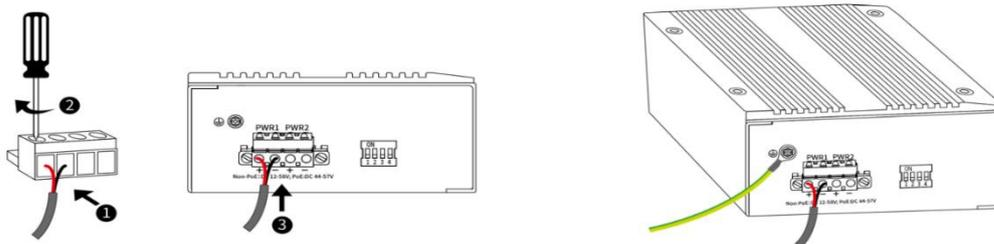
**注意:** 接続ミスを避けるため、端子台接続用の DC 電源レセプタクル上のプラス (+) とマイナス (-) の表示を確認してください。
